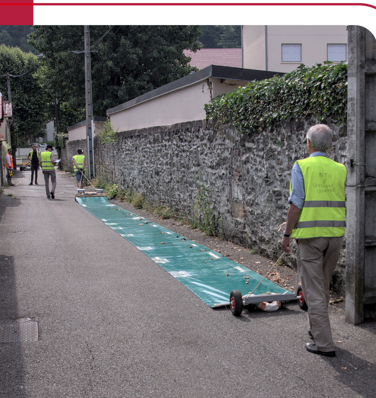
Prospection électrostatique à Vienne (38) pour la recherche du cirque gallo-romain. Crédit : Christophe Benech
