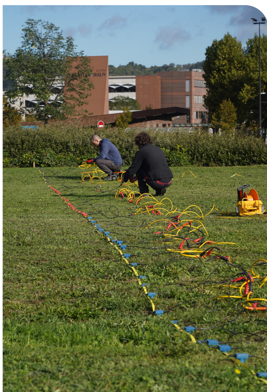
Mise en place du dispositif pour la prospection sismique en ondes de surface. Crédit : Christophe Benech
