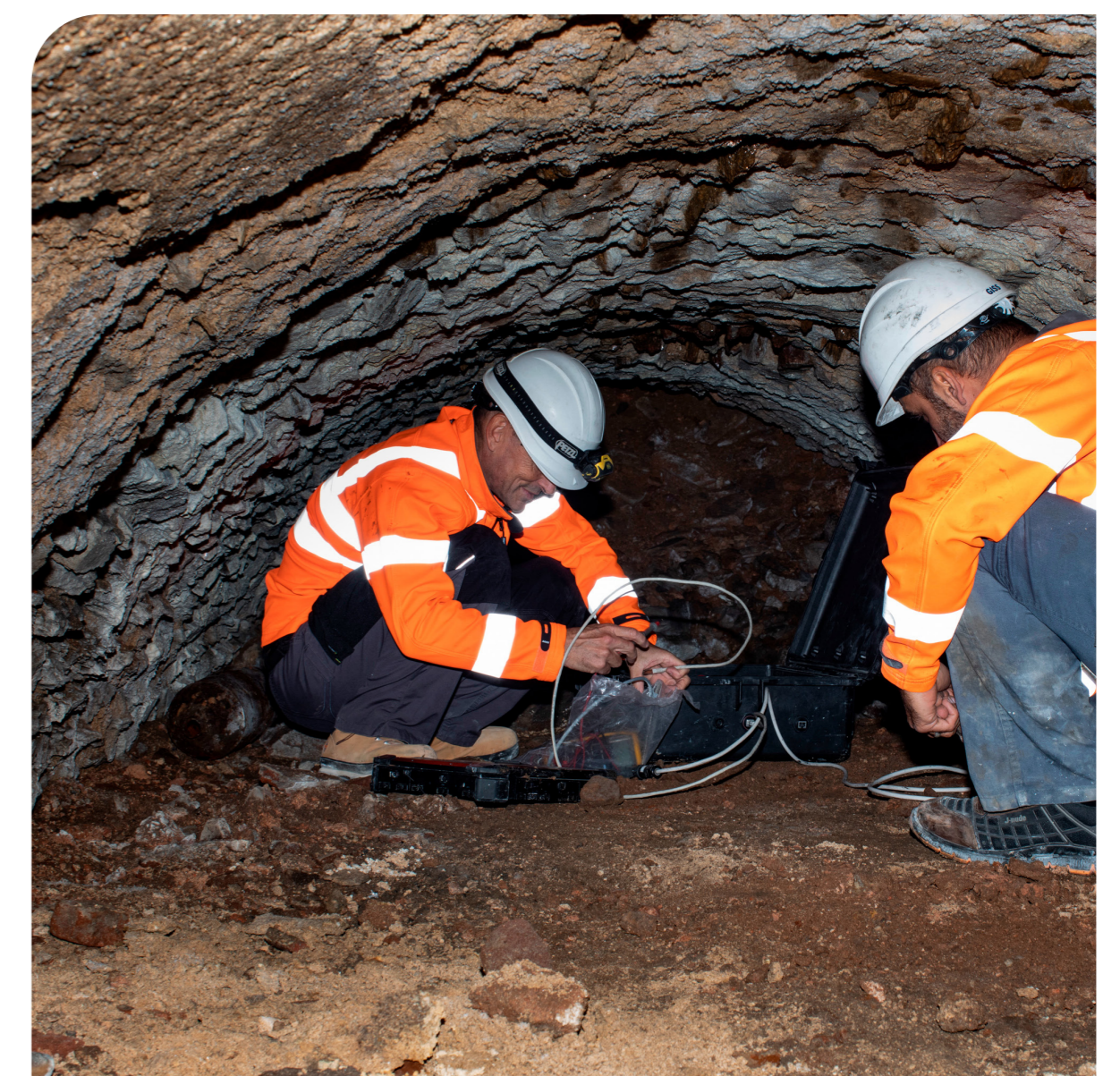
Installation du compteur de muons dans la galerie la plus profonde et partiellement comblée du Palais du Miroir. Crédit : Carol Müller
